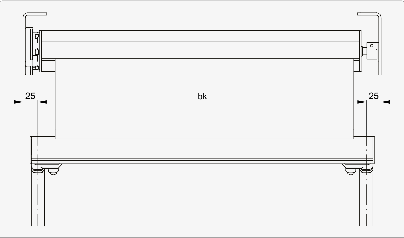
Horizontalschnitt: Einbausystem in Sturznische
